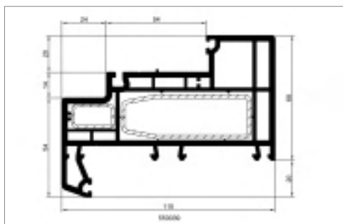
Kozijnprofiel naar buiten draaiend met vaste aanslag
